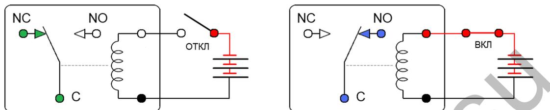
Рис. 4. Релейные выходы контроллера RME-22.
